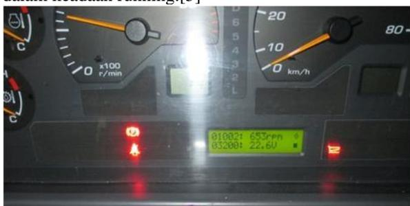
Gambar 3. Tegangan pengisian kurang dari 26 V Contoh kasus charging failure, ketika dilakukan pengecekan tegangan pengisian dari alternator, tegangan kurang dari 26 V (spesifikasi standar pengisian HD 785-7).
