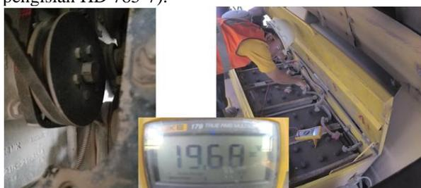
Gambar 4. Pemeriksaan baterai ketika trouble *can't start*, tegangan kurang dari 24 V
