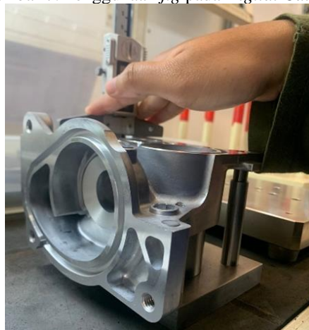
Gambar 8. Penggunaan jig pada Depth Caliper
